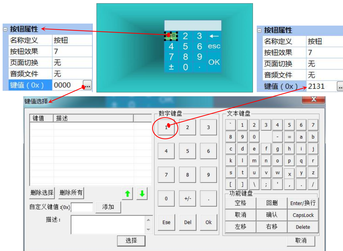
图 5-3-2 数字键盘按钮 1 的键值设置过程
